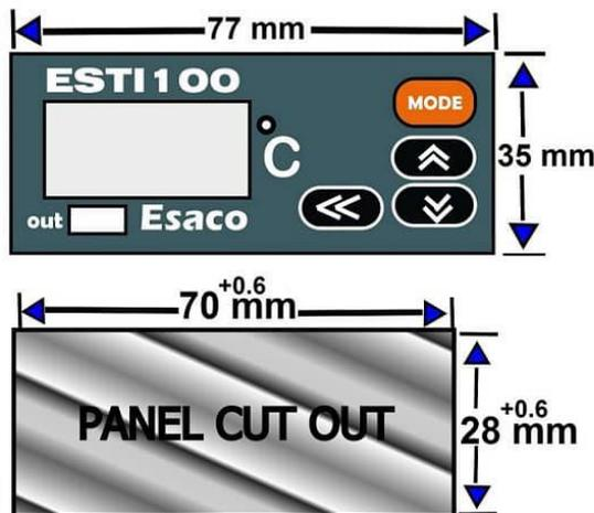
ابعاد برش جهت قرار گیری پنل روی درب تابلو در ابعاد عکس می باشد همچنین برای برش می توانید از فرم پشت چسبدار داخل جعبه مطابق
