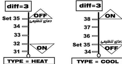
**۴- تنظیم رله به عنوان (سیستم سرمایشی یا گرمایشی)**
